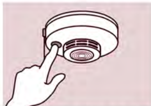
②住宅用火災警報器を定期的に点検し、10年を目安に交換する。
